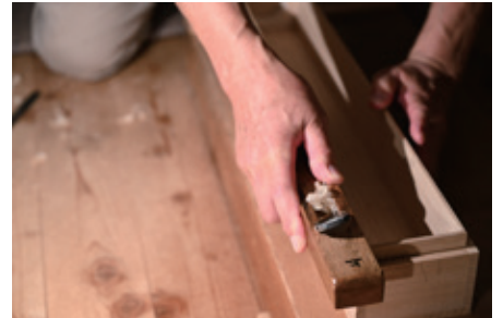
仕上がり具合がよくわかるよう、作業中は裸電球の明かりのみ。慎重に少しずつ面を整えていく。
