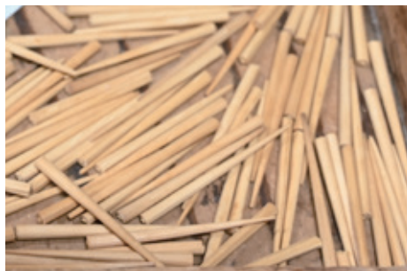
製作に必要な材料を自作することも。写真はウツギの棒を削って作った木釘。
