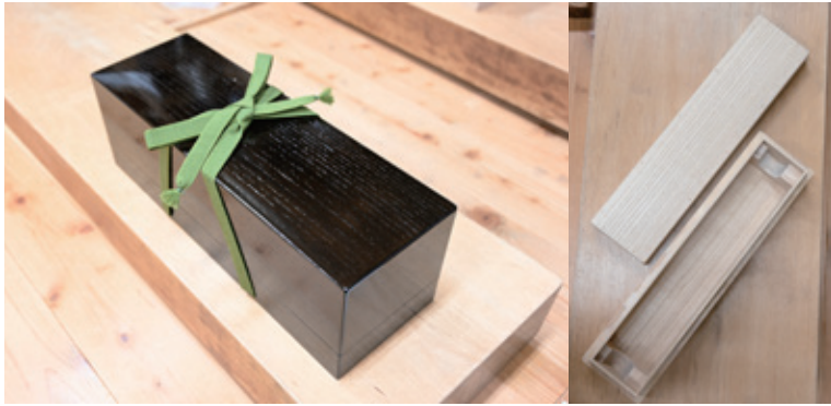
大坂さんが製作した桐箱のサンプル。漆塗りの外箱（左）に付けられた紐は市村さんの真田紐。白木の内箱（右）には掛け軸を固定する軸受けがついている。
